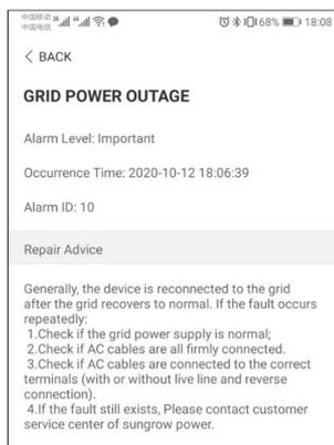
**Figura 7-9** Informações detalhadas do alarme de falha
