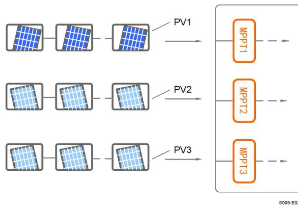
**Figura 5-2** Configuração de entrada FV(SG9.0/10RS-L, por exemplo)
