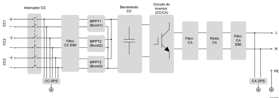
**Figura 2-5** Diagrama do circuito (SG10RS-L, por exemplo)
