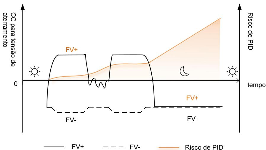
**Figura 2-6** Risco de PID de inversores tradicionais
