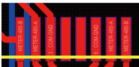
Esquemático do RJ45 para a porta MODBUS para monitoramento
