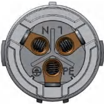
Figura 4.13 Conector do terminal de grade CA interno
