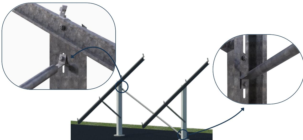
Assim, no início e final de cada fileira, deve-se instalar a barra de corta de vento, que funciona como contraventamento da estrutura.
