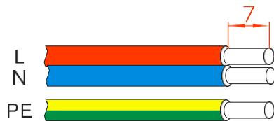
Figura 3-21 Ilustração da remoção do cabo de saída CA (unidade: mm)
