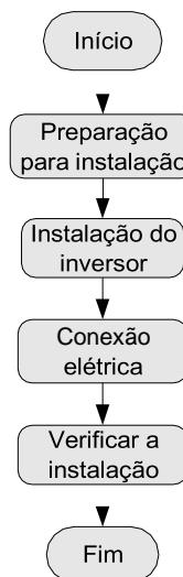
Figura 3-1 Processo de instalação
