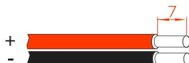
Figura 3-16 Ilustração da remoção do cabo de entrada CC (unidade: mm)
